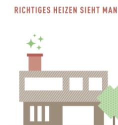
Ob richtig geheizt wird, sieht man an der Rauchentwicklung am Kamin. Wird mit einem hochwertigen Brennstoff, in einer intakten Heizanlage richtig geheizt, ist der Kamin bereits nach wenigen Minuten rauchfrei.
